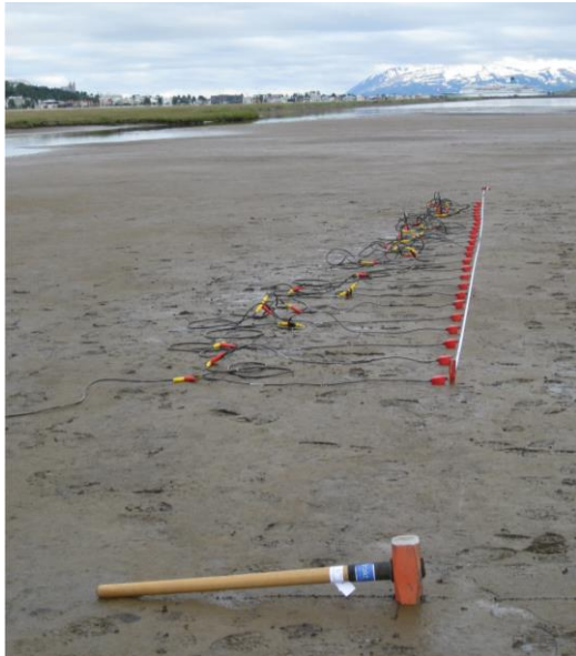
Mynd 3: Dæmi um uppstillingu mælikapals og 24 hraðanema við framkvæmd MASW mælinga. Höggálag er framkallað með því að slá með sleggju á yfirborð jarðar við enda nemaraðarinnar.
