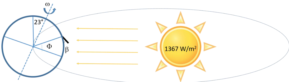
Mynd 2: Inngeislun sólar á hallandi flöt ræðst af breiddargráðu ( \Phi ), hvernig jörðin snýr gagnvart sólu (ræðst af tíma dags og árstíð) og halla flatar ( \beta ) frá láréttu.
